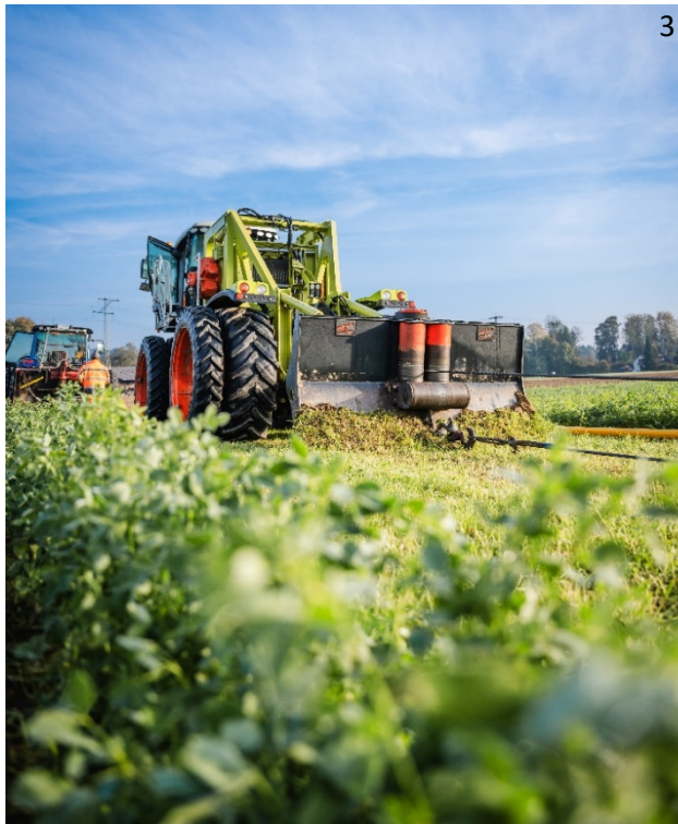
Bild 3: Leistungsstarke 30-Tonnen-Winde als Zuggerät Quelle: Regio Energie Solothurn
